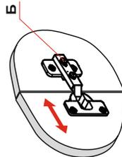
**В) Регулирование наклона**
