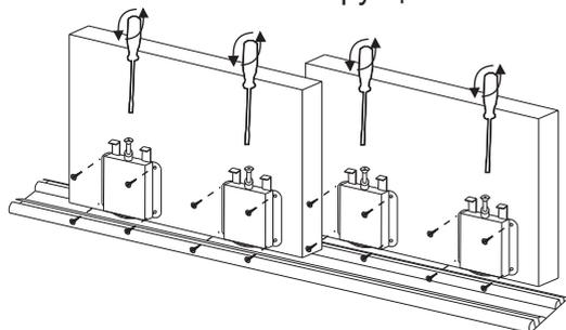
Ослабьте регулировочный болт на роликах SMT 75 T в нижних частях двери. Вставьте верхние ролики в паз профиля, потяните вверх рычаги на нижних роликах и установите дверь на нижний профиль. Отрегулируйте двери.
